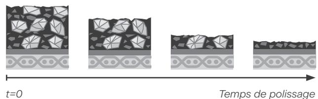
Le processus de fabrication spécifique de **VSM ILUMERON** se traduit par une répartition homogène des grains dans l'épaisseur de l'abrasif appliqué, qui s'use complètement et progressivement sur une période de temps.
